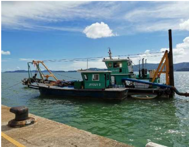
รูปที่ 2.3.9-5 ตัวอย่างเรือขุดลอกแบบหัวสว่าน (CUTTER SUCTION)
