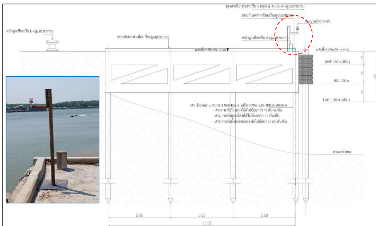
รูปที่ 2.3.3-25 ไฟล์สัญญาณกระพริบแสดงตำแหน่งโครงสร้างท่าเทียบเรือ
