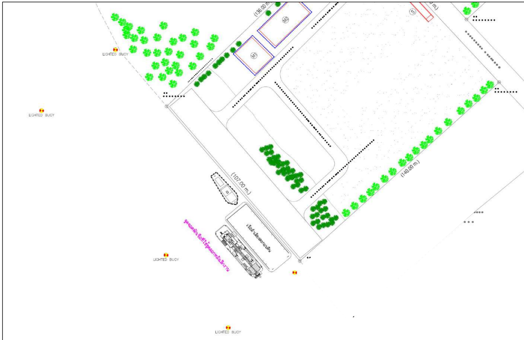
รูปที่ 2.3.9-6 แสดงตำแหน่งทุ่นแสดงขอบเขตและจุดจอดเรือที่ใช้ในการขุดลอกภายหลังการเลิกงานในแต่ละวัน
