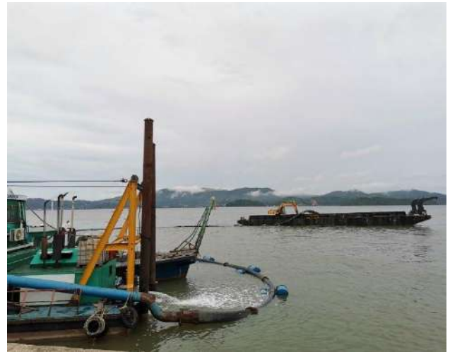
รูปที่ 2.3.9-5 ตัวอย่างเรือขุดลอกแบบหัวสว่าน (CUTTER SUCTION)
