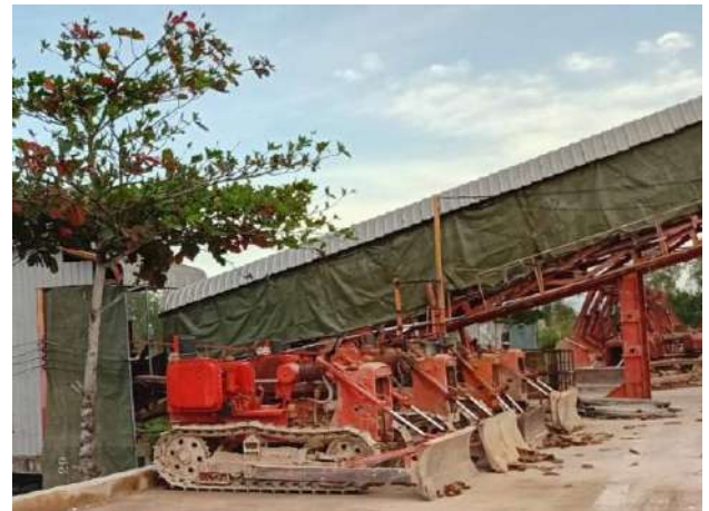
การปิดคลุมด้วยผ้าใบและตาข่ายกันฝุ่นตลอดแนวสายพาน ปลายปล่องปล่อยสินค้าและเสารับโครงสร้างอย่างมิดชิด
